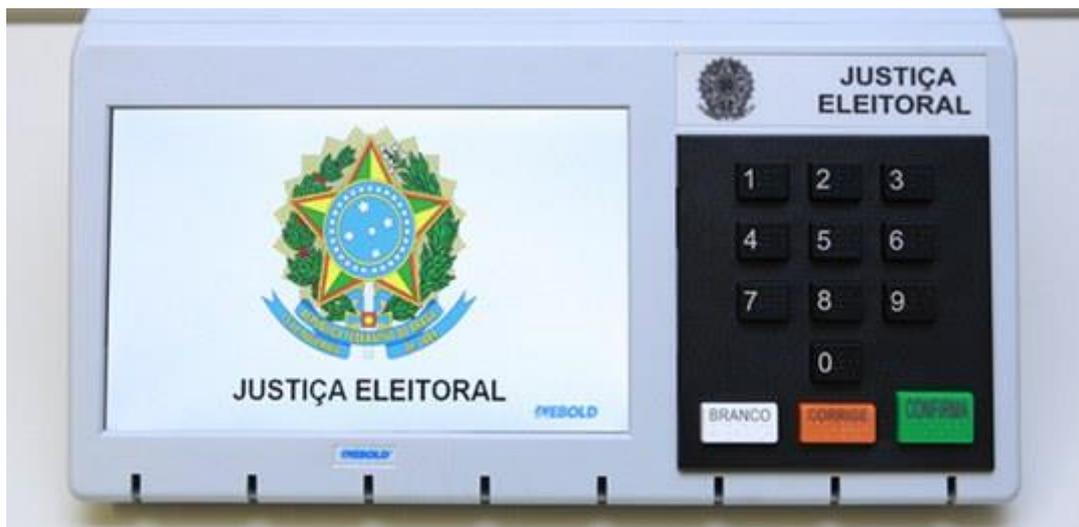
A urna eletrônica é um microcomputador de uso específico para eleições, com as seguintes características: resistente, de pequenas dimensões, leve, com autonomia de energia e com recursos de segurança.
